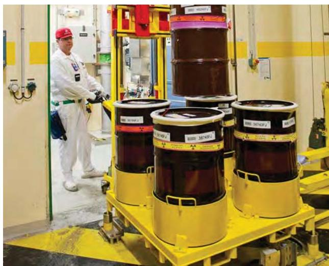
Après collecte et avant expédition, les déchets radioactifs pré conditionnés en fûts sont entreposés dans des locaux spécifiques. Les déchets radioactifs sont confinés sous double enveloppe plastique soudée, placée dans les fûts métalliques qui assurent la protection. Les entreposages de déchets radioactifs sont regroupés dans des secteurs de feu et de confinement\* efficaces même en cas d'incendie.
