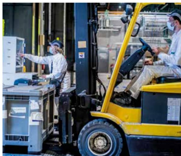
suivantes : réception des déchets radioactifs solides ; caractérisation, tri et contrôle des déchets entrants ; découpe, compactage, broyage et conditionnement ; entreposage avant expédition vers des centres de stockage agréés.
