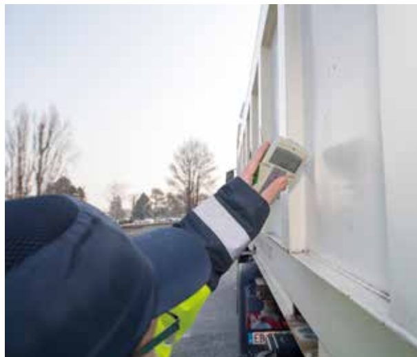
Contrôle radiologique avant expédition d'un colis vers sa filière d'élimination.
