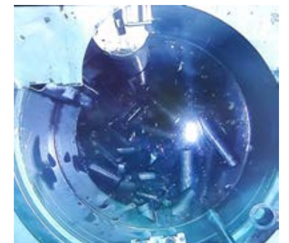
Photo 6 : Déchets de la 1ère grappée dans le fût ECE
