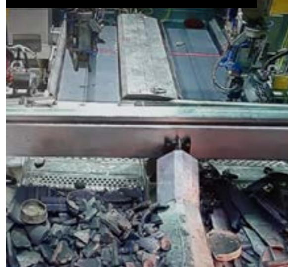
Photo 5 : robots de dépose des déchets sur les convoyeurs pour procéder à la reconnaissance de forme
