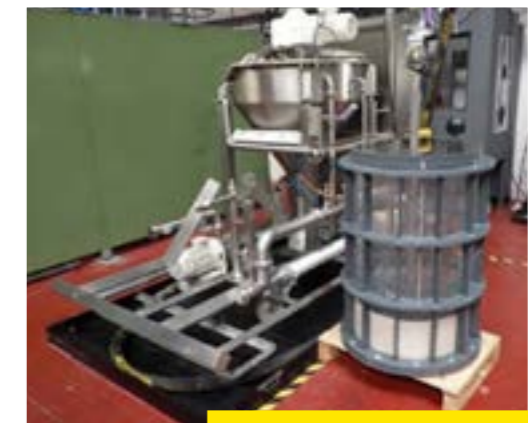
Photo 7 : poste de remplissage des étuis
