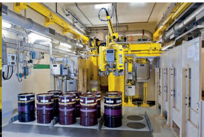
Mesure automatisée de matière radioactive dans des fûts de déchets
