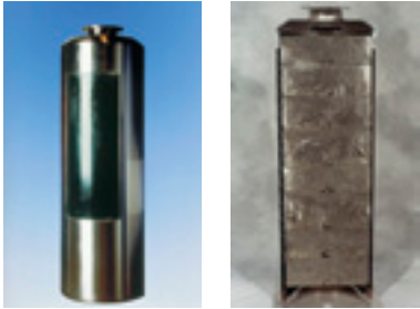
Conteneurs standard de déchets vitrifiés et compactés.
