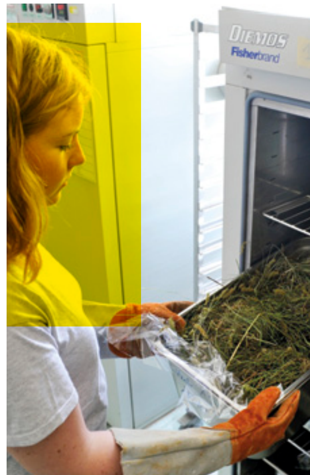
Étuvage d'échantillon d'herbe avant broyage.
