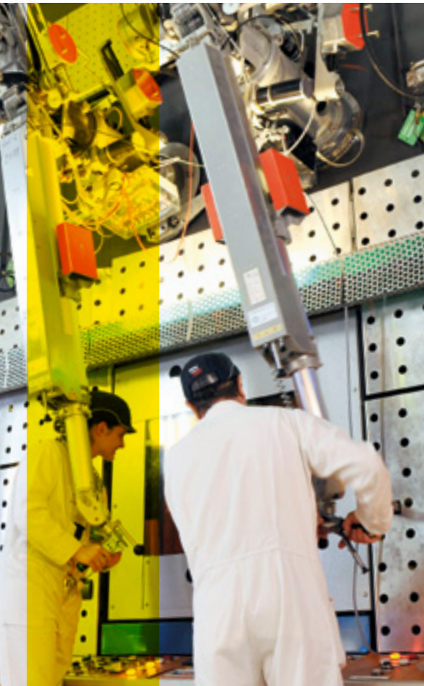
Opération de désentreposage de déchets vitrifiés avant retour vers un client étranger.
