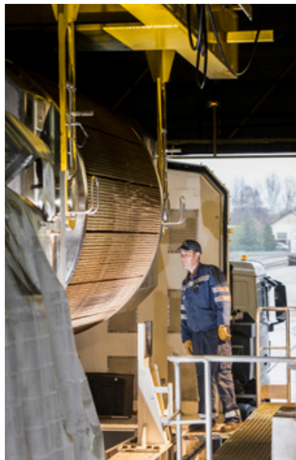
Arrivée d'un emballage de combustibles usés.
