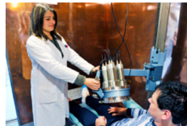
Spectrométrie qui mesure la radioactivité dans le corps humain.
