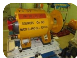
Emballage spécifique pour Co60 Specific container for Co60
